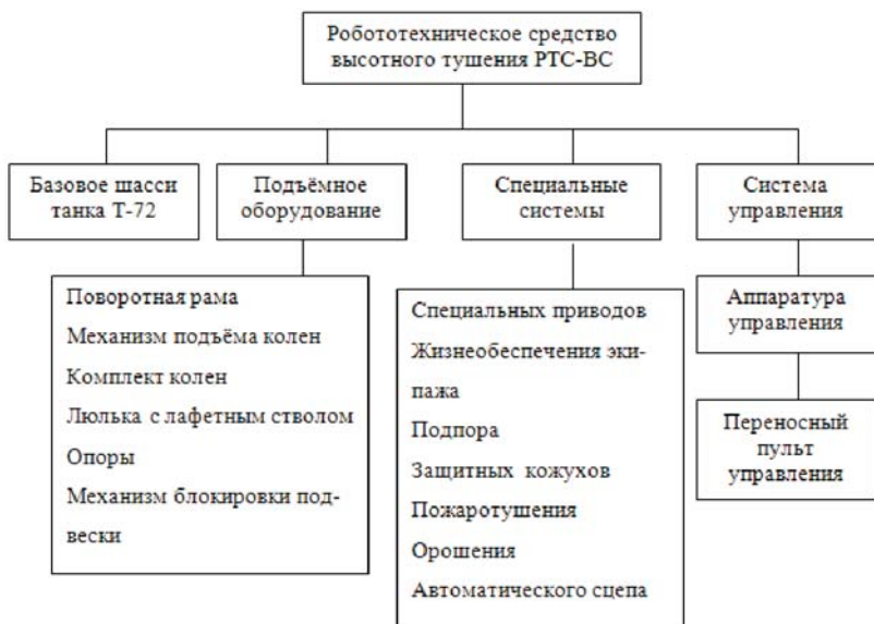
Рис. 7. Схемно-конструктивное построение пожарного РТС-ВС высотного тушения
