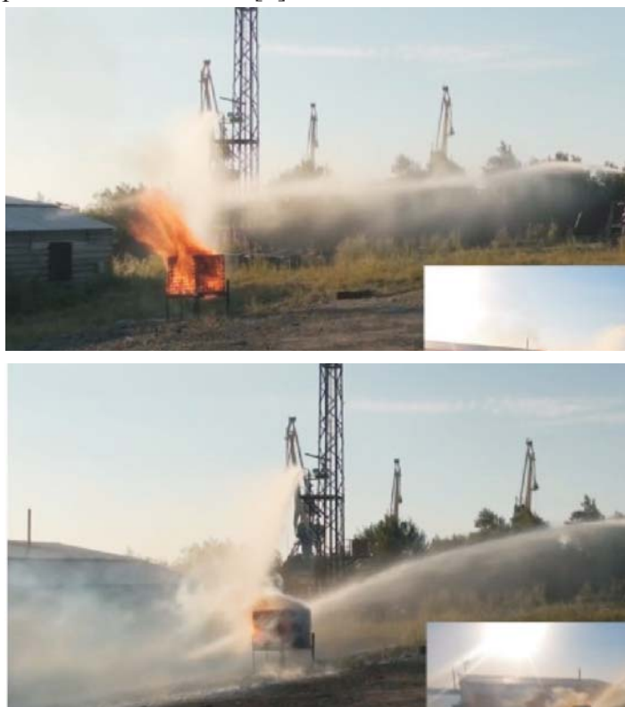
Рис. 2. Тушение модельного очага пожара при испытании мини-роботов
