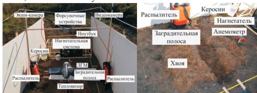
Рис. 1. Типичная фотография, полученная при проведении экспериментов по локализации распространения фронтов горения и пиролиза хвои
