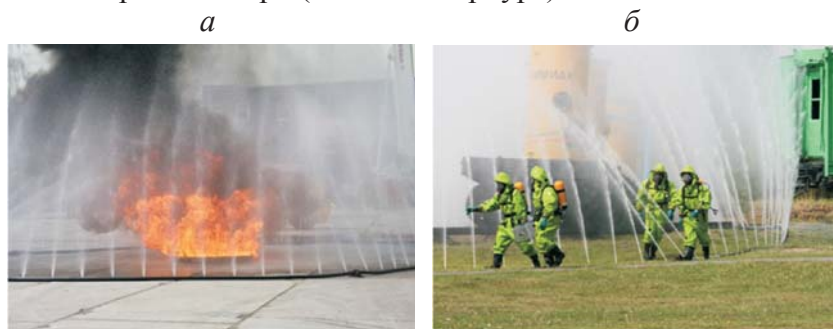
Рис. 1. Пожарные рукава «Ливень» в работе:
